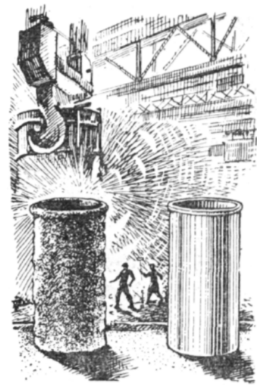
Кремнеорганические соединения, добавленные в формовочную и стержневую смеси, позволяют получать литые металлические детали с гладкой поверхностью.
